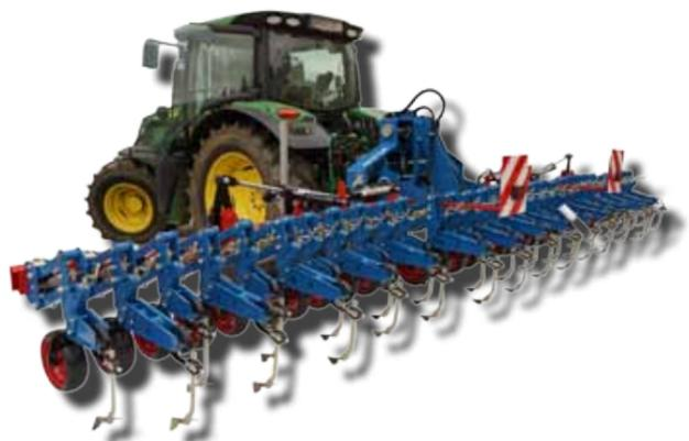
Bineuse 32 rangs avec la caméra de guidage
