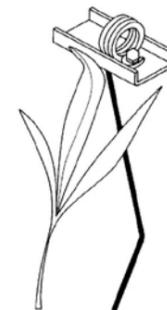
Dispositif de protection des ressorts empêchant le pincement de la pointe des plantes
