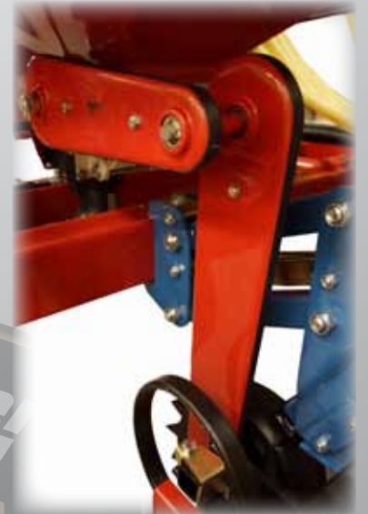
Cassette d'entraînement entraînée par la roue de terrage
