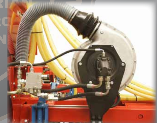
Ventilateur entraîné par moteur hydraulique
