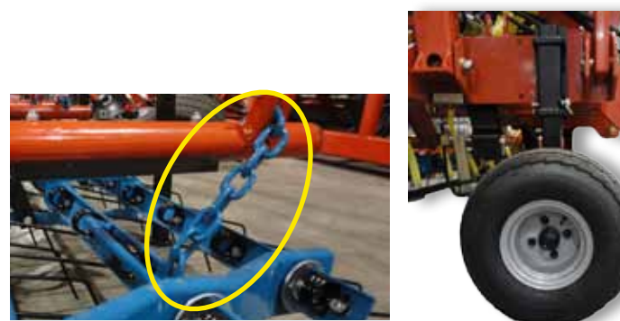
Chaque champ est herse à guillotine simple de chaînes pour assurer l'adaptation au sol optimale
