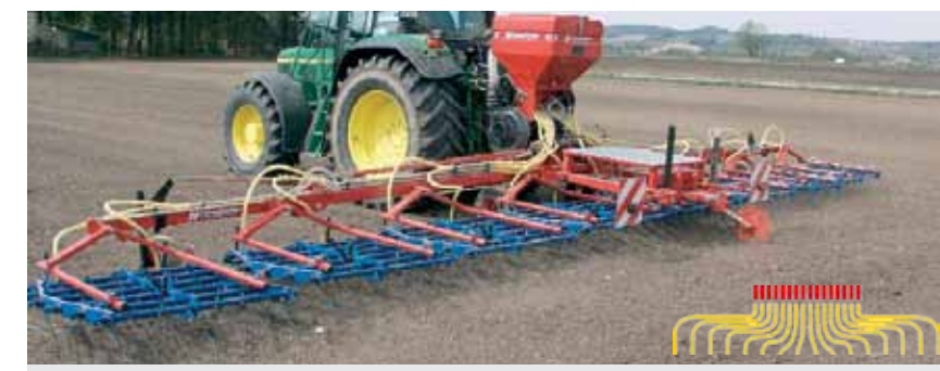
Herse étrille en largeur de travail 9 m avec semoir pneumatique, sursemis
