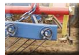
Herse étrille, largeur de travail 5 m, semis d'engrais verts, éparpilleurs montés sur champs de travail
