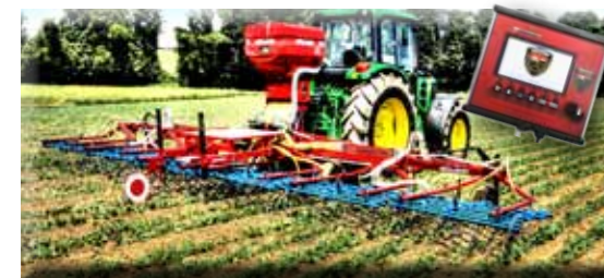
Herse étrille en largeur de travail 9 m avec semoir pneumatique
