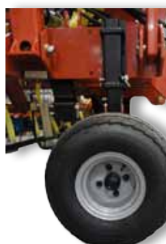
Roue de terrage à hauteur variable avec moyeu avec coulement à billes
