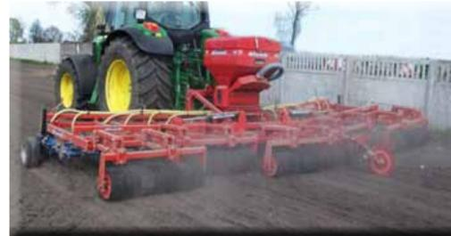
Vertikator „Hegler Sepp“, strong version, 6m working width
