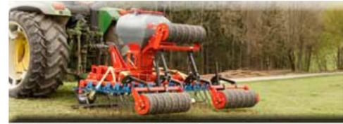
Vertikator mit neu konstruierter Walzenaufhängung
