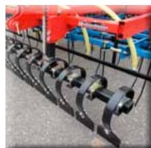
Einzeln montierte, gefederte Streifbleche
