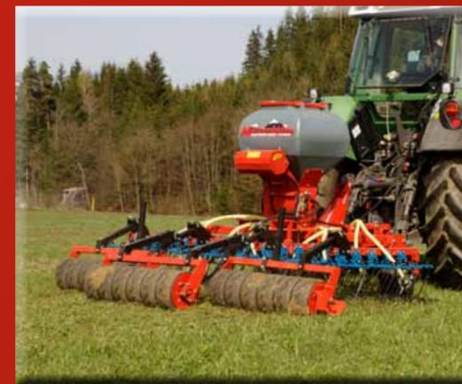
Hatzenbichler Vertikator mit Farmflexwalze und pneumatischem Sägerät „Air 8“
