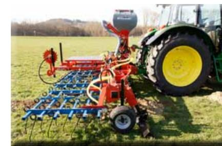
Vertikator 6m schwere Ausführung mit pneum. Sägerät „Air 8“
