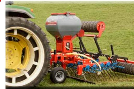
Vertikator mit neu konstruierter Walzenaufhängung
