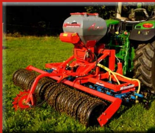
Hatzenbichler Vertikator „Alpin“ mit pneumatischem Sägerät „Air 8“
