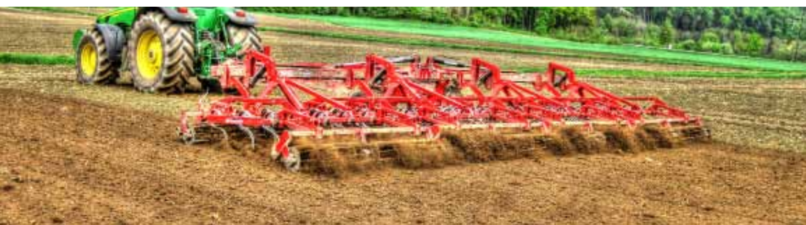
Arbeitsstellung, 10m Aufsattelkombination
