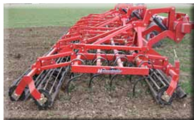
Arbeitsstellung, 10m Aufsattelkombination
