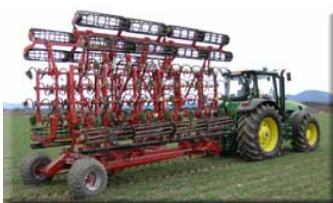
Transportstellung, 10m Aufsattelkombination
