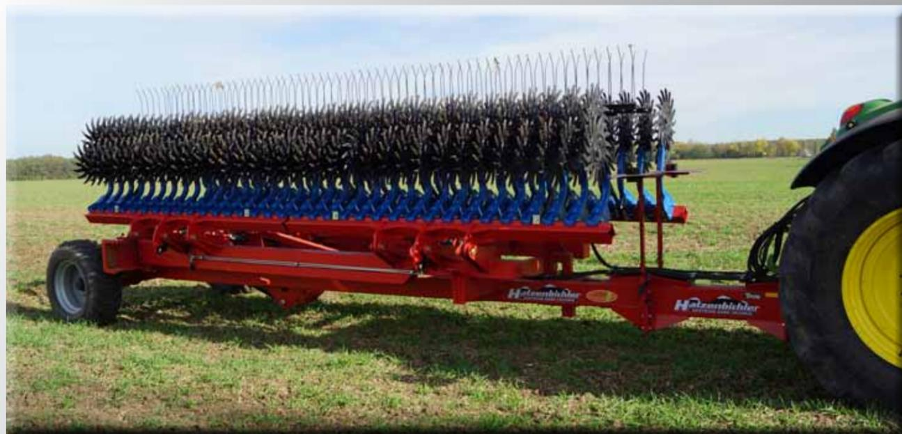
12,20m Rotor-Striegel in Transportstellung
