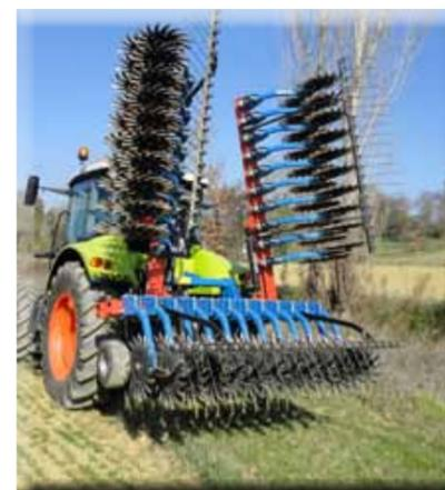
Rotor-Striegel 2,50m Transportbreite
