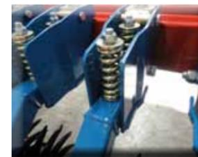
⇒ Mit 2 Federn pro Werkzeugträger wird ein Druck von ca. 50kg auf den jeweiligen Stern ausgeübt.
