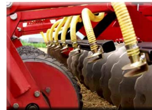
Exakte Ausbringung durch optimale Anordnung und Anstellwinkel der Prallbleche, welche auf speziellen Schienen montiert werden
