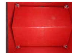
Schutzplatte der Säwelle, damit **nicht** das gesamte Gewicht des Saatgutes auf die Säwelle drückt und Brückenbildung verhindert wird.
