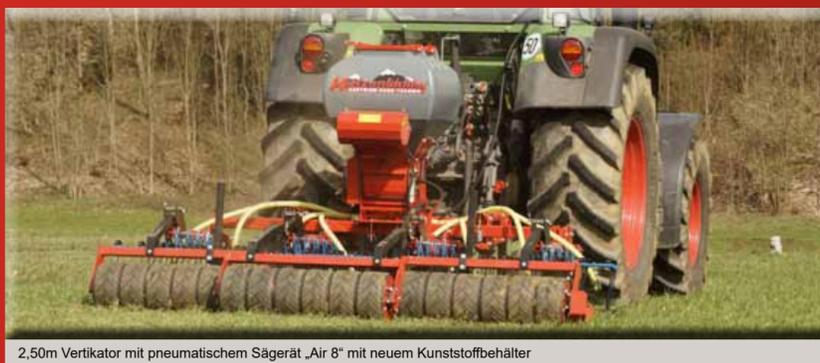
2,50m Vertikator mit pneumatischem Sägerät „Air 8“ mit neuem Kunststoffbehälter
