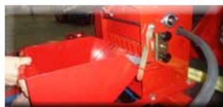
Abdrehwanne zum Auffangen des Saatgutes bei der Abtriebprobe
