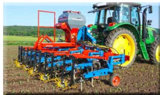
Hackmaschine mit „Air 8“ für Zwischenfruchtanbau
