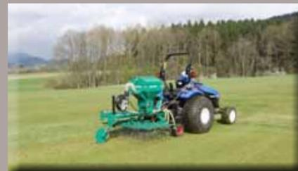
Golfstriegel 1,50m Arbeitsbreite mit pneum. Sägerät „Air 8“
