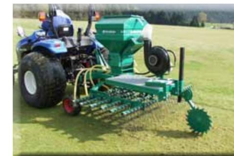
Golfstriegel 1,5m Arbeitsbreite mit pneum. Sägerät „Air8“
