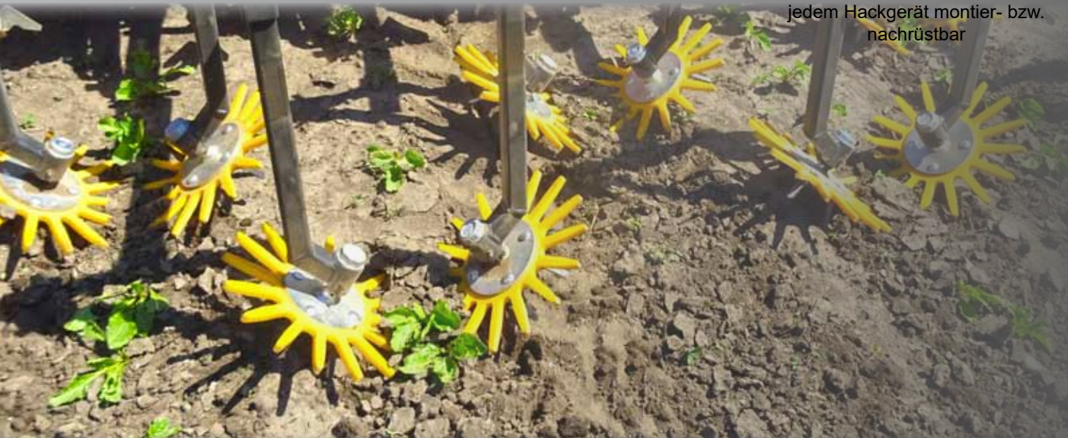
Reihentaster Optionale Ausstattung für alle Hackmaschinenvarianten montierbar
