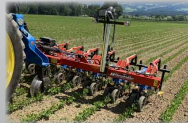
Duplex-Hackmaschine mit kameragesteuerter Autolenkung
