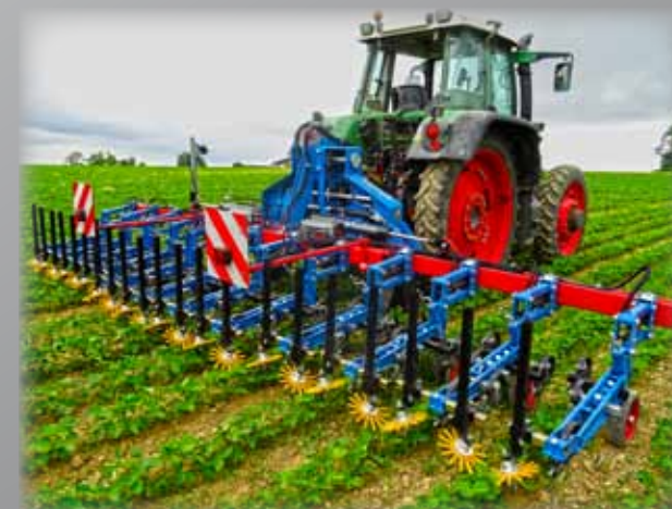
11-reihige Sojahacke mit Hydraulikzylinder an jedem einzelnen Parallelogramm zur autom. Reihenaushebung
