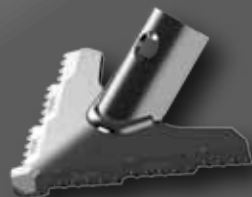
Hartmetall Gänsefußschare 150mm, mit aufgelöteten Hartmetallplättchen
