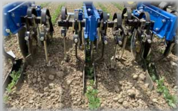
Duplex-Hackmaschine - Duplex-Zinkenkopf mit Schneidscheiben, Vibrofederzinken und L-Messer
