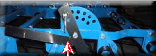
10 Lochverstellung der Zinkenaggressivität
