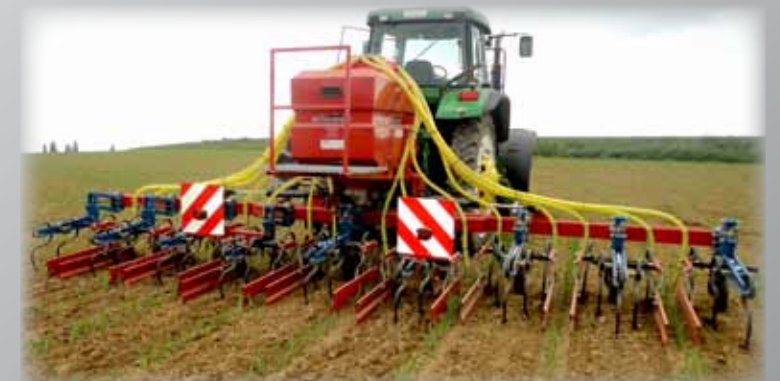
8-reihige Maishackmaschine mit pneum. Düngerstreuer
